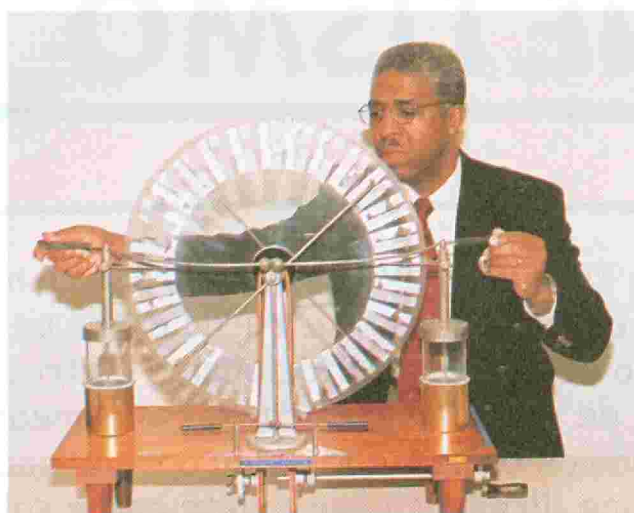
Jim Stith, antigo presidente da “American Association of Physics Teachers” (Associação Americana de Professores de Física), demonstra o funcionamento de um gerador de Wimshurst que produz relâmpagos em miniatura.
